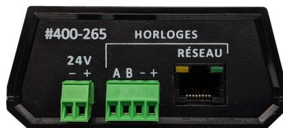
Sur le connecteur RJ45 reliés au Réseau Horloges le DEL jaune témoignent de l'alimentation raccordée sur le bornier d'alimentation externe et le DEL vert clignote au grès des informations qui y voyagent.
